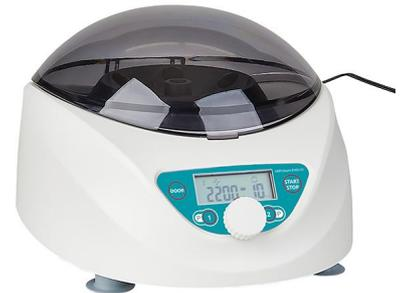
Kompakte Tischzentrifuge für Praxis und Labor mit Winkelrotor für bis zu 6 x 15 ml.
